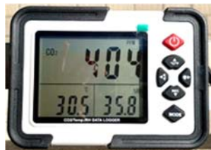
Fig. 4. Equipo de medición portátil, modelo CDP-H2008.
